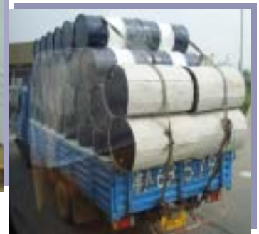
天津出光潤滑油廠 200Lタイトヘッド(板厚:天地1.0mm、胴0.9mm)
