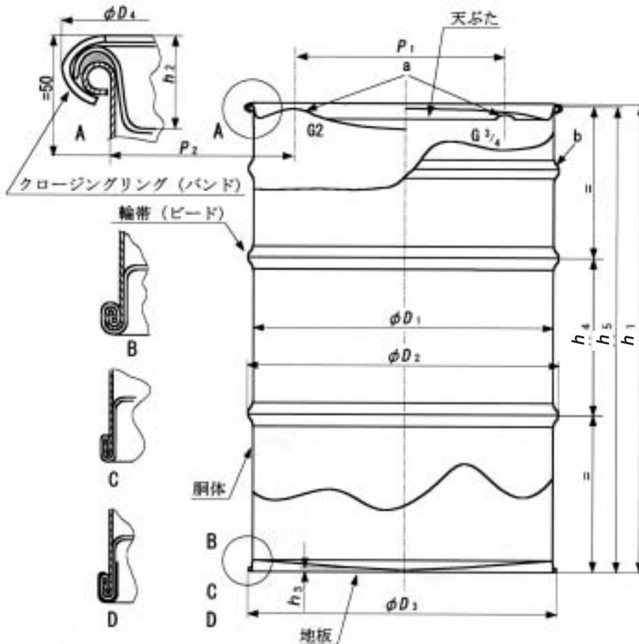
備考 上図は、ドラムタイプBとDの詳細を示している。天板の形状として凸、平たん、凹の三つの可能性があることを示している。Aは天ぶたにガスケットを装着して、クロージングリング(バンド)で胴体に締め付けた状態を示す。B、Cは、巻締め形状を示す。Bはラウンドシーム、Cはダブルシームの一例を示す。Dはチャイムに覆輪を取り付けた状態を示す。
