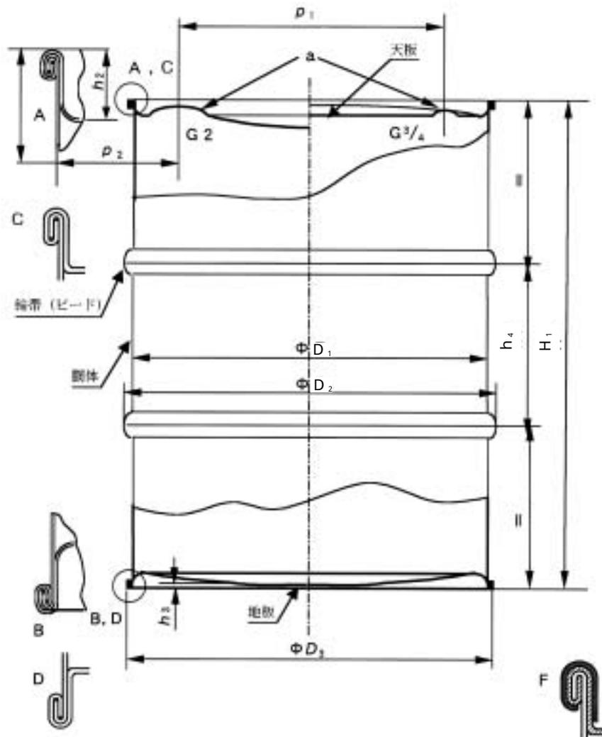
備考 上図は、天板の形状として凸、平たん、凹の三つの可能性があることを示している。A、B、C、Dは、巻締め形状を示す。A、Bはラウンドシーム、C、Dはダブルシームの一例を示す。Eは、チャイムに覆輪を取り付けた状態を示す。a: 最終仕上がりの口金(プラグ、キャップシール又はオーバーシール)がチャイムの上端から突き出てはならない。
